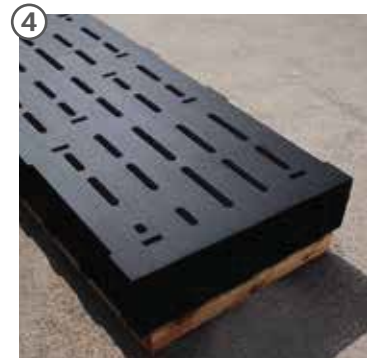
entsprechend der erstellten CAD-Zeichnung werden die Schlitzte mit innovativer Wasserstrahl-Schneidetechnologie passgenau in die Matten geschnitten
