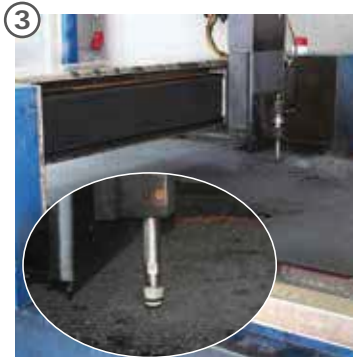
entsprechend der erstellten CAD-Zeichnung werden die Schlitzte mit innovativer Wasserstrahl-Schneidetechnologie passgenau in die Matten geschnitten
